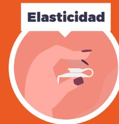
La **ELASTICIDAD** del material permite que su vástago, en forma de pinza abierta, se vaya cerrando gradualmente a medida que es introducido en un orificio.
